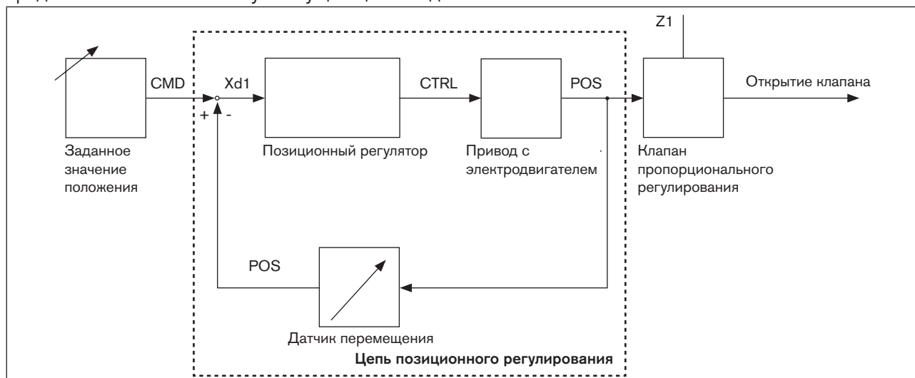
Рис 3: Диаграмма потока сигналов позиционного регулятора
