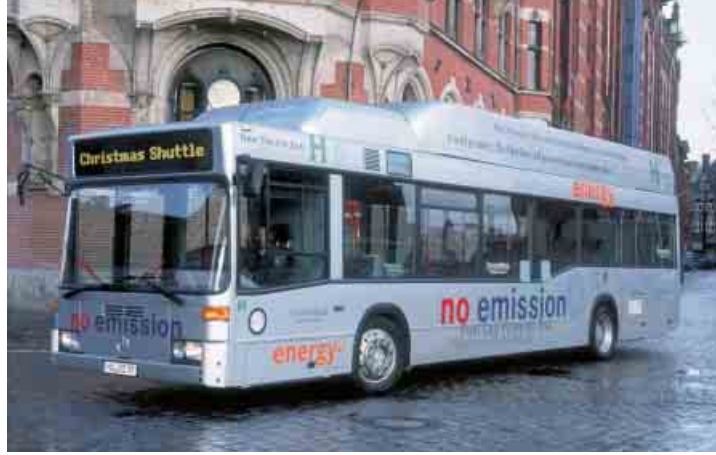
Auch für die Automobilindustrie ist Wasserstoff interessant – als Energieträger für den Antrieb von Fahrzeugen. Das Foto zeigt einen Linienbus mit Wasserstoffantrieb.
